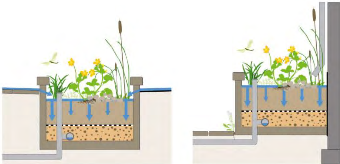
Schematische doorsneden van watervasthoudende plantenbakken. ©Atelier GROENBLAUW
