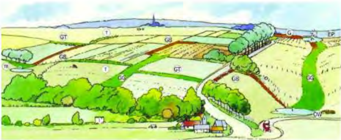
GG = grasgang, T = talud, TB = beboste talud, EP = erosiepoel, OW = overstroombare weide, G = gracht, GT = gracht met talud, GB = buffergracht.
