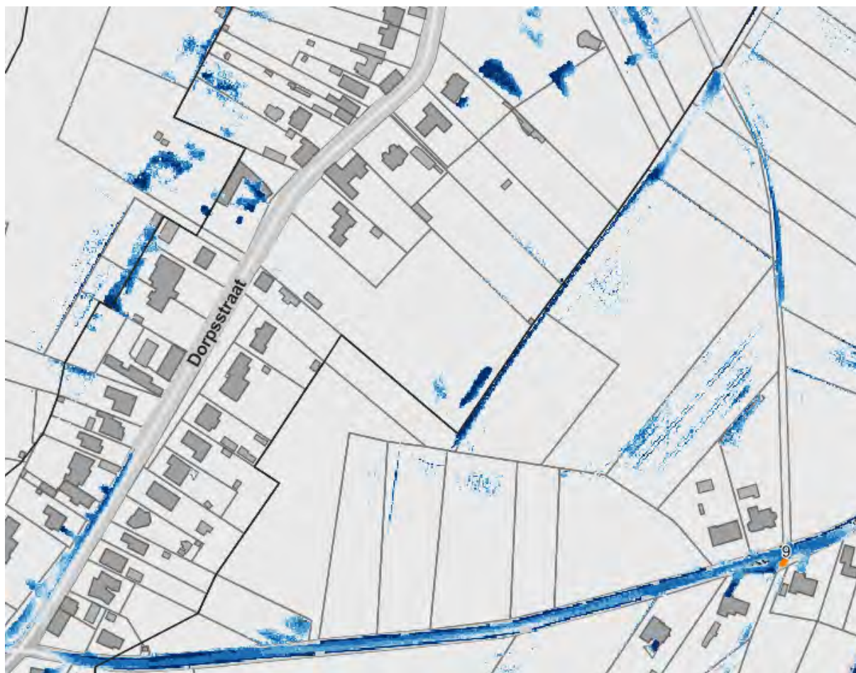
Figuur 22: Identificatie van potentiële zones voor infiltratie/buffering via watersysteemkaart (microschaal).
