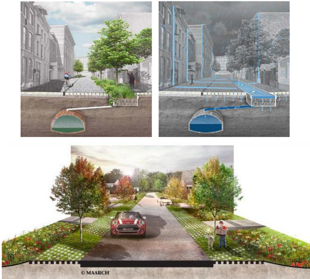
Figuur 34. Herinrichting van straten, met integratie van groenvoorzieningen en infiltratie, naar aanleiding van rioleringswerken: 1) binnen het verstedelijkt gebied (Leuven, bron: De Urbanisten) en 2) in straten met meer ruimte voor voorzieningen ( Heusden-Zolder , bron: blauwgroenvlaanderen)
