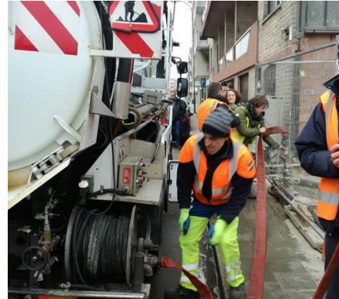
Figuur 31. Hergebruik van bemalingswater: via opslag tanks in Nevele (links, bron: HLN) en vullen van veegwagens in Brussel (rechts, bron: OpenSource Brussels).
